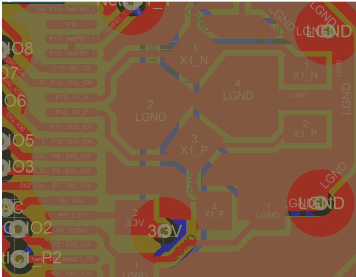
Figura 4.10: Plano de masa continuo sobre las pistas de alta frecuencia del oscilador a cristal.
